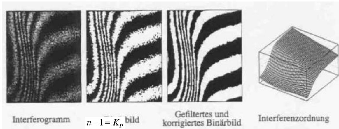
**Abbildung 6.3-2 Arbeitsschritte der Interferogrammauswertung mit dem Streifenverfolgungsverfahren am Beispiel eines Interferogrammausschnittes.**
