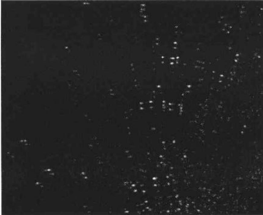
**Abbildung 6.2-25** Beispiel für die gute Bildqualität, die mit der Dunkelfeldholographie erzielt werden kann (dargestellter Bildbereich:  $2,0 \cdot 2,4 \text{ mm}^2$ ). Durch Doppelbelichtung entstehen zu jedem Tropfen zwei Bildpunkte und eine Geschwindigkeitsbestimmung wird möglich. Die mittlere Tropfenkonzentration im dargestellten Bildbereich betrug  $5 \cdot 10^5 / \text{cm}^3$ .
