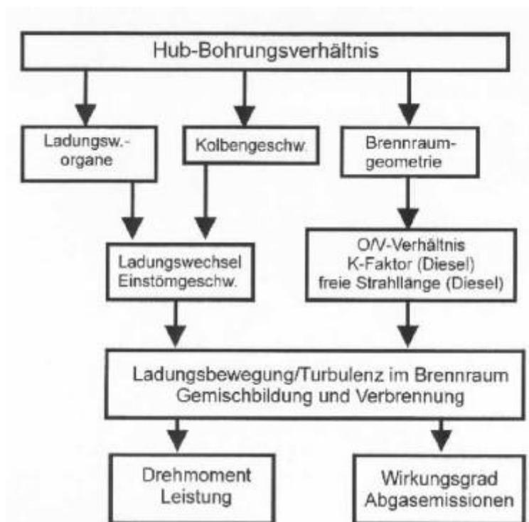
**Abbildung 5.1.-3 Einfluß des Hub-Bohrungs-Verhältnisses auf die thermodynamischen Motoreigenschaften**
